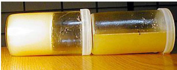
**Figura 15.** Amostra de biodiesel de soja B100 sem aditivo (esquerda) e com aditivo, na mesma temperatura e inferior ao do ponto de fluidez do EMS
