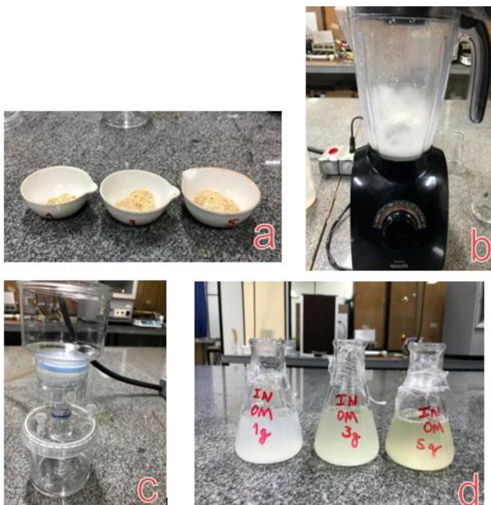
Figura 1. a - Semente de moringa separada em cadinhos com 1, 3 e 5 gramas; b - Semente de moringa sendo triturada em solução aquosa; c - Processo de filtração a vácuo; d - Coagulantes orgânicos com concentrações distintas
