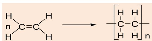
**Figura 1.** Reação de produção de polietileno a partir da polimerização do etileno
