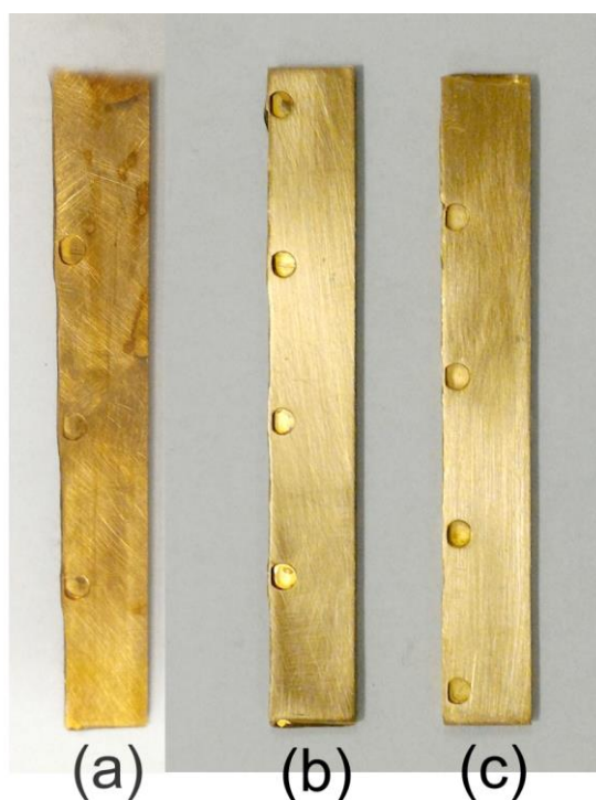
Figura 5. Placas de cobre pós-ensaio (a) QAV puro (b) KE100 (c) Placa pré-ensaio
