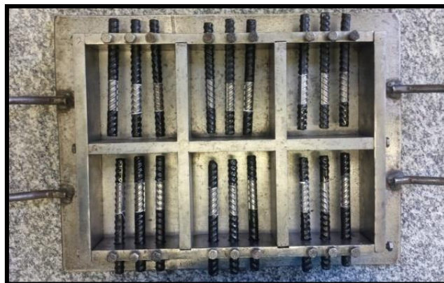
Figura 1. Molde de aço para os corpos de prova utilizados nos ensaios eletroquímicos
