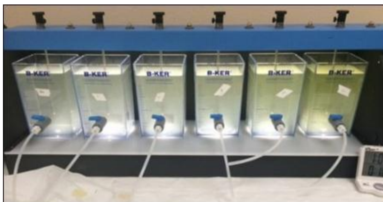
Figura 5. Jar Test utilizado para determinação de condições ótimas de coagulação, floculação e decantação 29
