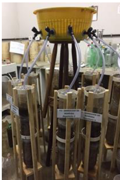
Figura 2. Detalhe do ensaio experimental utilizando filtros orgânicos no processo de filtração
