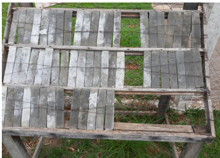
Figura 1. Disposição dos corpos de provas para envelhecimento
