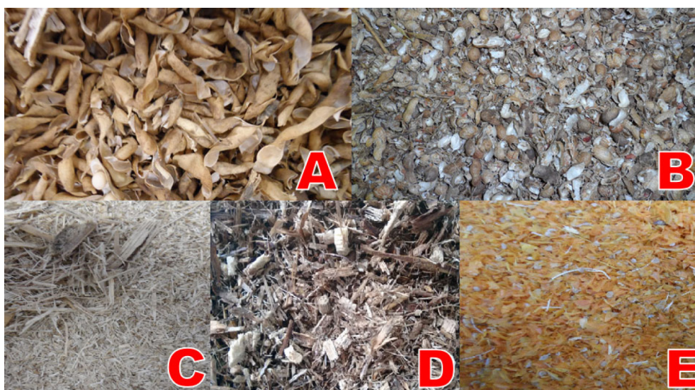
Figura 1. Casca de soja (A), casca de amendoim (B), bagaço de cana-de-açúcar (C), bagaço de sorgo sacarino (D) e bagaço do extrato de tomate (E)
