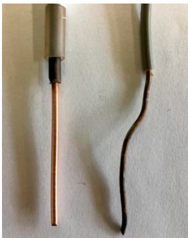
Figura 4. Aspecto dos eletrodos de cobre antes e depois da eletrólise. (Eletrodo da esquerda: antes do experimento – Eletrodo da direita: após o experimento)
