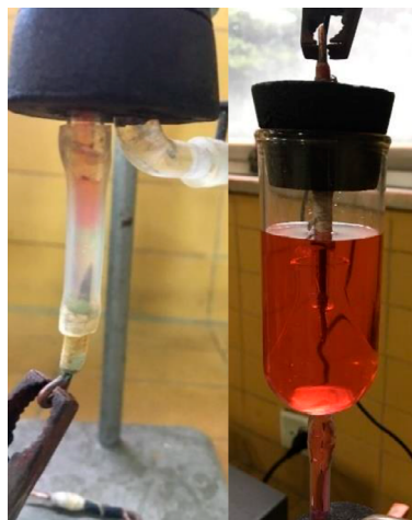
Figura 5. Formação da fronteira móvel no início do experimento (esquerda). Parte superior do aparato com o catodo fixado na rolha (direita)
