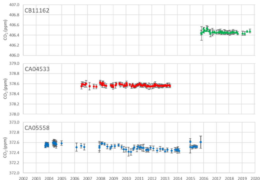
Figura 8. Série temporal de medidas de target tank para os cilindros CA05558, CA04533 e CB11162
