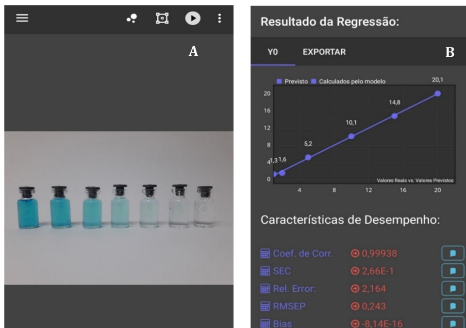
Figura 6. Soluções de corantes utilizadas na construção da curva analítica (A) e resultados da regressão obtidos pelo aplicativo (B)
