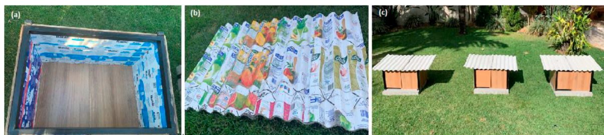
Figura 1. Modelo de residências: (a) com revestimento vertical (b) com revestimento horizontal (c) visualização da condição de ensaio dos três modelos
