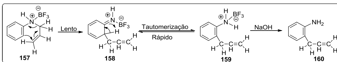
Esquema 37. Mecanismo do rearranjo de 3-aza-Cope catalisado por \text{BF}_3 \cdot \text{OEt}_2
