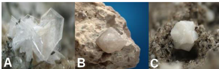
Figura 3. Fases da sílica em sua forma cristalina - (A) Tridimita; (B) Quartzo; (C) Cristobalita. (Reprodução da ref. 107 com autorização. Copyright © 2005-2010 A.C. Akhavan)
