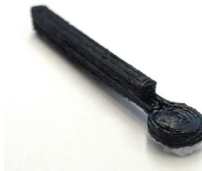
Figura 7. Eletrodo impresso com filamento de ABS com 20% em massa de negro de fumo (Vulcam XC72R, Cabot)
