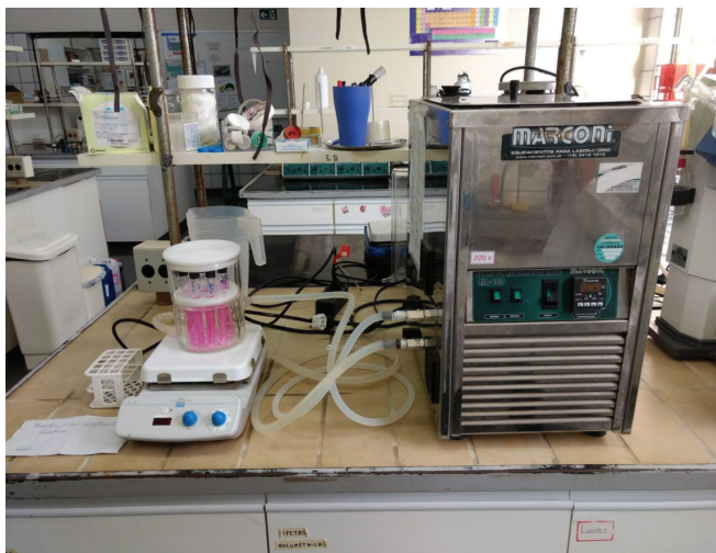
Figura 3. Sistema utilizado na incorporação da RB nas membranas de PA12 à temperatura controlada de 25 °C
