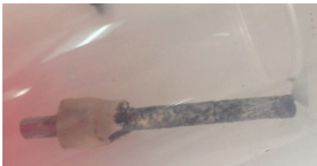
Figura 9. Electrodo de Fe empleado como ánodo tras la aplicación del tratamiento electrocinético
