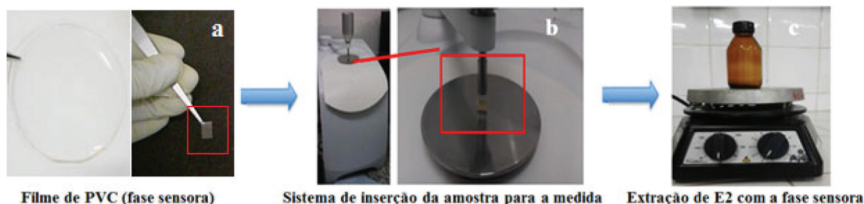
Figura 1. Esquema do procedimento realizado para obtenção dos dados. (a) corte da fase sensora, (b) análise espectroscópica no UATR e (c) meio aquoso sob agitação onde a fase sensora era exposta por tempo determinado
