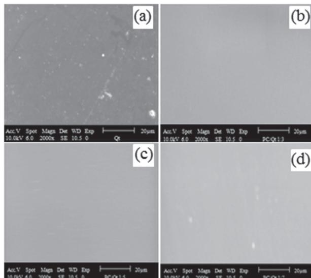
**Figure 5.** Micrographs of the films: (a) Qt; (b) PC/Qt 1:3; (c) PC/Qt 1:5 and (d) PC/Qt 1:7.
