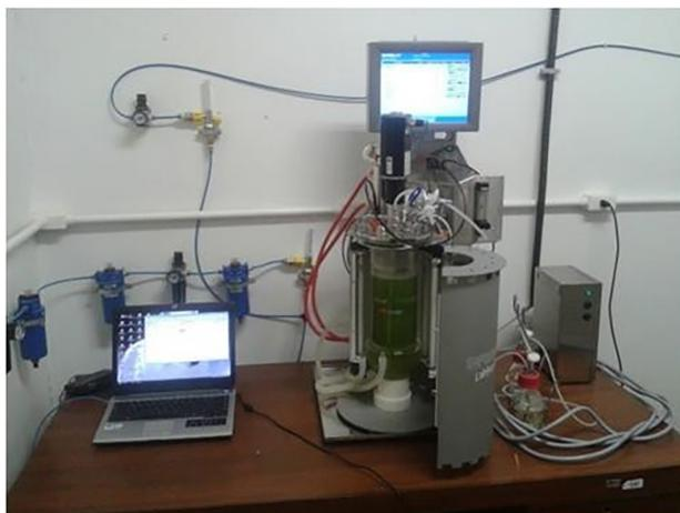
**Figure 1.** Photobioreactor. Source: Laboratório de Materiais e Combustíveis (LMC), Instituto de Química, UnB, 2014).
